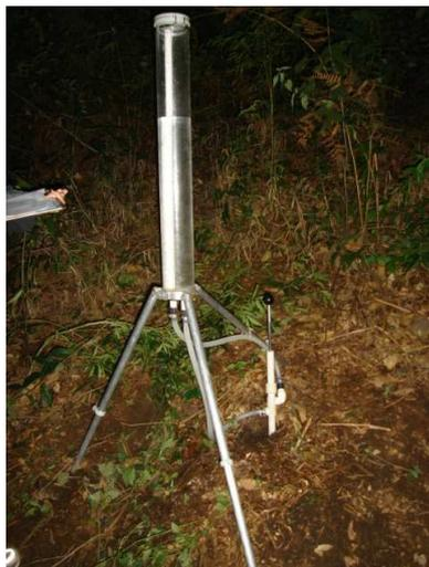
Figura 2: Permeâmetro de Guelph Modificado utilizado no campo.
